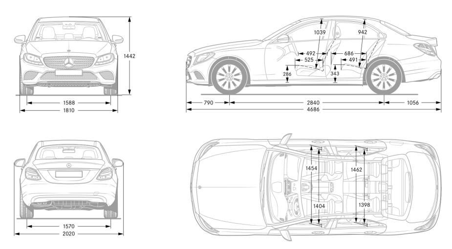
Все размеры указаны в миллиметрах. Указанные габариты являются средними значениями. Они действительны для автомобилей в базовой комплектации без загрузки.
