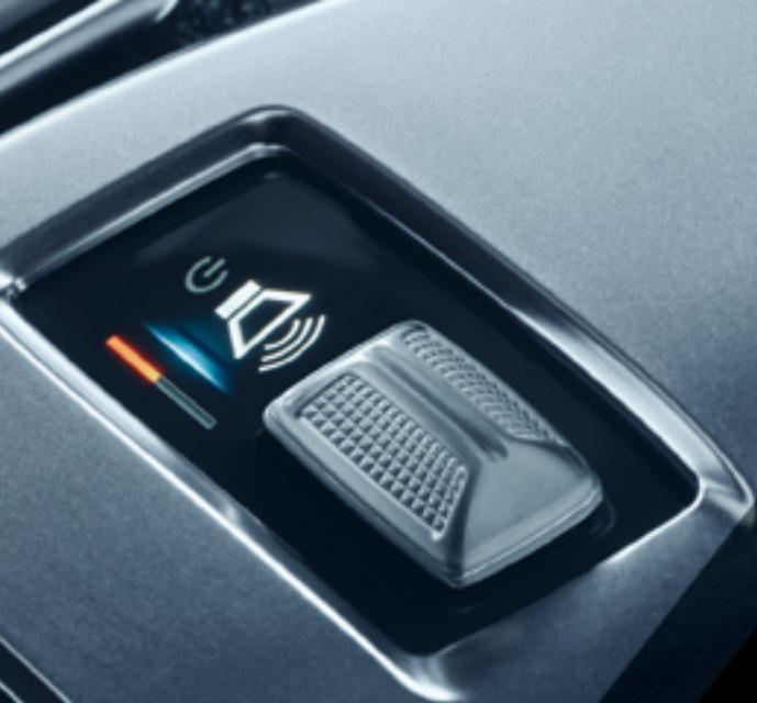
Новое и уникальное на центральной консоли: восемь интегрированных дисплейных кнопок для управления режимами движения, коробкой передач, ходовой частью, системой ESP®, выхлопной системой, функцией ECO Start/Stop, громкостью и антикрылом.
