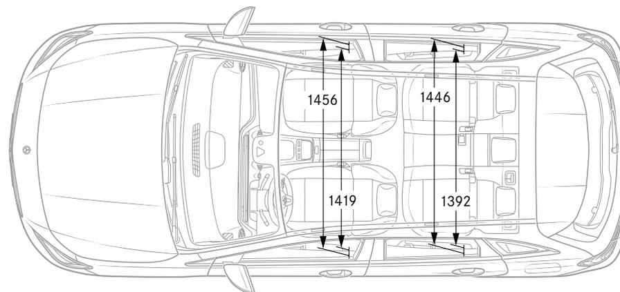
Все размеры указаны в миллиметрах. Указанные габариты являются средними значениями. Они действительны для автомобилей в базовой комплектации без загрузки.
